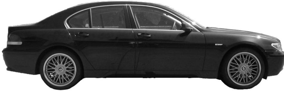
Schliesslich nahmen wir uns vor, ein dreidimensionales Modell der ganzen Karosserie zu erhalten. Die insgesamt  $52 \times 19 = 988$  Stützpunkte sollten sowohl in Längs-, wie auch in Querrichtung durch kubische Splines verbunden werden, und wir strebten eine dreidimensionale Darstellung an. Um vorerst nur die Messwerte zu visualisieren, gaben wir sie in MATLAB ein:
